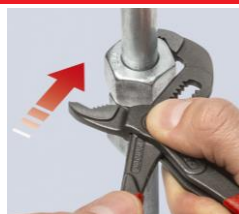
回転方向と逆向きにオフセットされた歯によるセルフロック効果
