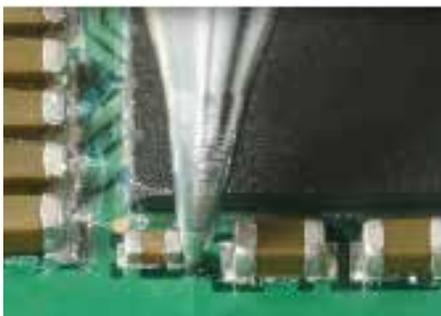
◇顕微鏡下での狭ピッチ間にある微細チップ (0603) などのんだ付けに最適。こて先が細いだけでなく、こて先の熱容量をあげることで精密機器の品質安定やタクトタイムの短縮まで見込めます。
