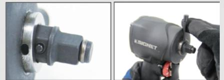
【アンビル取付】 根元のボタンを押し込み、
