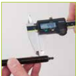
c 3つのネジ山の長さを測ります。
