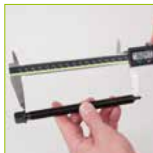
b スピンドルの先端までのネジの長さを測ります。
