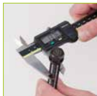
a スピンドルの直径を測ります。
