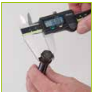
d スピンドルヘッドの六角形を測ります。
