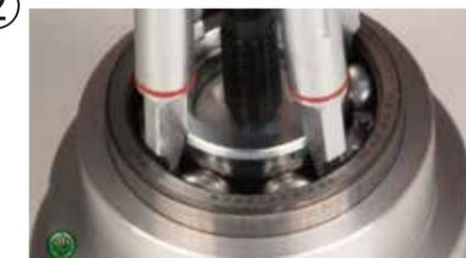
先端の爪を外輪のレースに内側から引っ掛けます。
