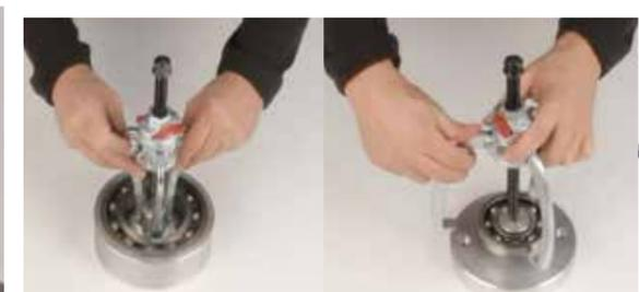
外抜き、内抜き双方簡単に設定出来ます。
