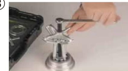
センターボルトをレンチで回し、引き抜きます。
