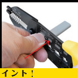
③ 親指で工具を押しながらケーブルを引く
