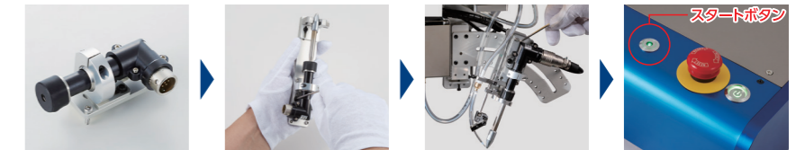
新しいこて部を用意します。 付属の治具を使って位置合わせをしておきます。 こて部を交換します。 ロボットを動かします。
