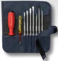
【セット内容】差替式ドライバーハンドル(8215.A)、差替式マイナスドライバーブレード(先端厚×幅:0.6×4.0、0.8×5.5、1.0×6.5、1.2×8.0)、差替式プラスドライバー(#1・2)、検電用ドライバー(先端厚×幅:0.5×2.5)、差替式リーマードライバーブレード(215.E)
