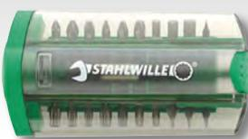
**[セット内容]**マグネットビットホルダー、プラスビット(#1・2・3)、ポジドライブビット(0.6x3.5・0.8x4.0・1.0x5.5・1.2x6.5mm)、六角ビット(4・5・6mm)、トルクスビット(T15・20・25・30)、いじりどめヘクスローブビット(T20・25・30)
