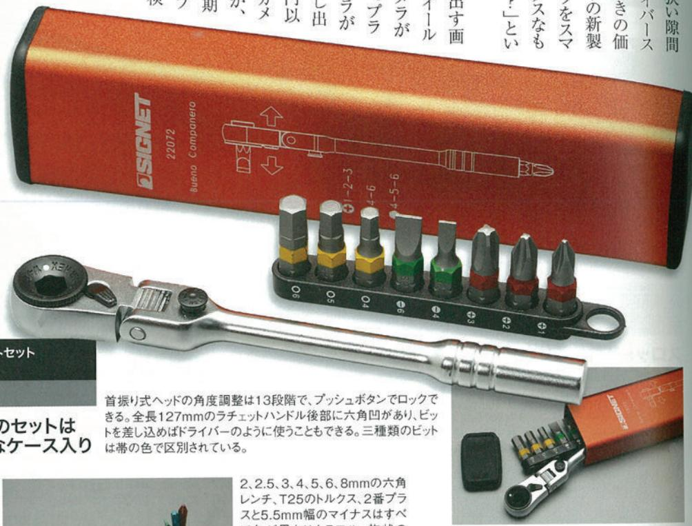
首振り式ヘッドの角度調整は13段階で、プッシュボタンでロックできる。全長127mmのラチェットハンドル後部に六角凹があり、ビットを差し込めばドライバーのように使うこともできる。三種類のビットは帯の色で区別されている。
