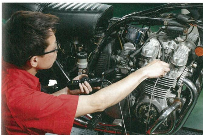
コンプレッショングージやリーキダウンスターで圧縮力不足を測定した後に、CCDカメラで確認することで分解前の検査や診断の精度を上げられる。鮮明な静止画や動画はスマホに記録できるので、ショップがユーザーに状況説明する際の有効な材料になる。
