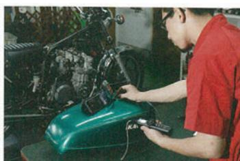
右回りのみのコントロールホイールを回すと、カメラの方向が滑らかに変わる。真正面しか映せないカメラだと見たい場所が見られないものがあるが、そんなストレスとは無縁。バルブにオイルが付着しているか焼けているかも一発で分かる。
